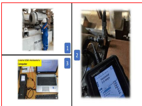
ภาพที่ 2.2-55 ระบบ Vibration Monitoring
